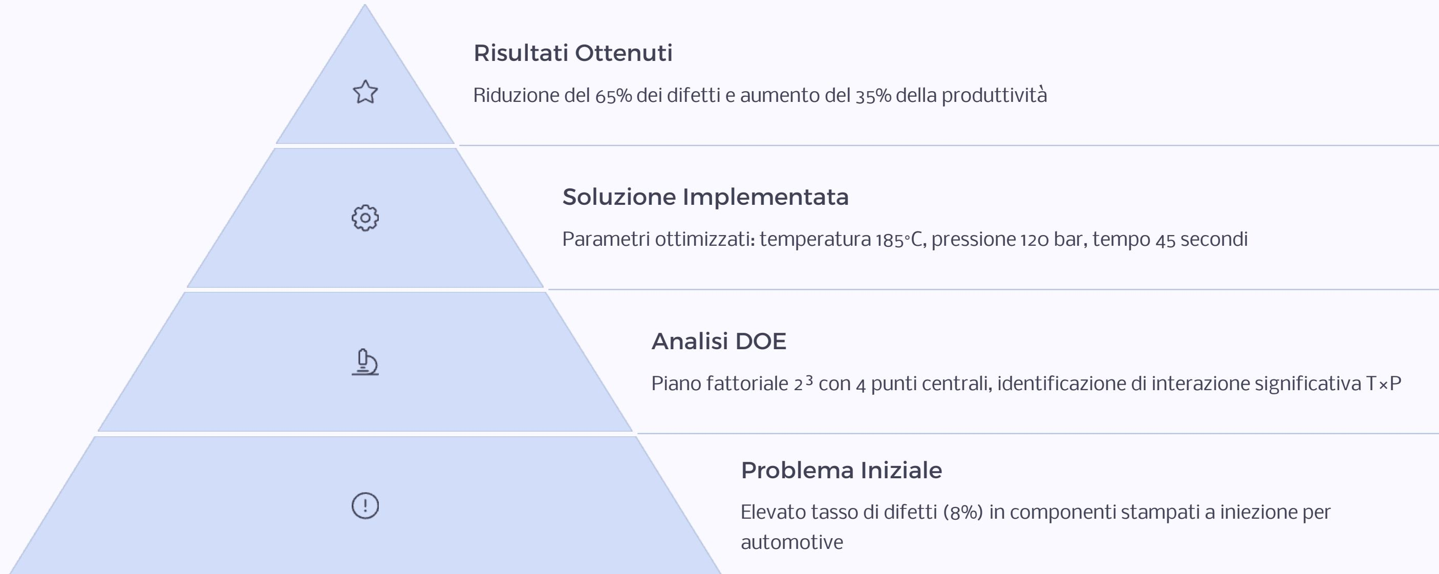
Un'azienda produttrice di componenti plastici per il settore automotive affrontava un problema di qualità con tassi di scarto inaccettabili. L'approccio tradizionale di regolazione dei parametri uno alla volta non aveva portato miglioramenti significativi. Applicando il DOE, è stata identificata un'importante interazione tra temperatura e pressione che non era stata precedentemente riconosciuta.
